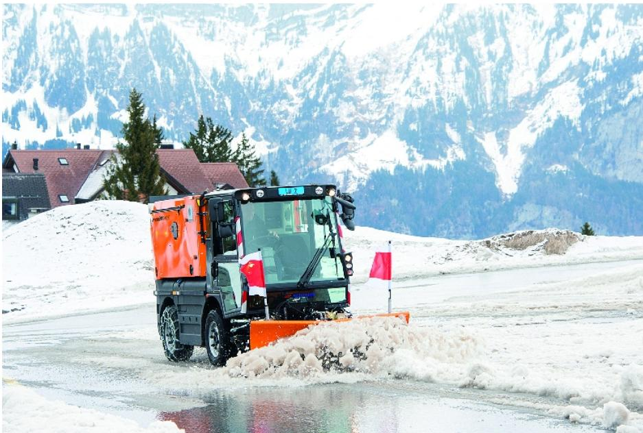
Auch für Kehrmaschinen oder Kleintraktoren bietet Schmidt mit der »EN«-Serie den passenden Leicht-Schneepflug.
