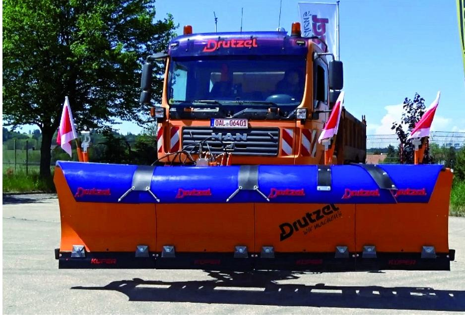
Ein Klappscharschneeflug von Drutzel. Die Arbeitsbreite kann durch das Einklappen einer Pflugschar (auch während der Fahrt) von 4,3 auf 3,3 m reduziert werden.
