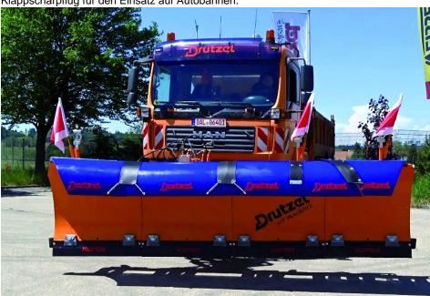
Ein Klappscharschneepflug von Drutzel. Die Arbeitsbreite kann durch das Einklappen einer Pflugschar (auch während der Fahrt) von 4,3 auf 3,3 m reduziert werden.
