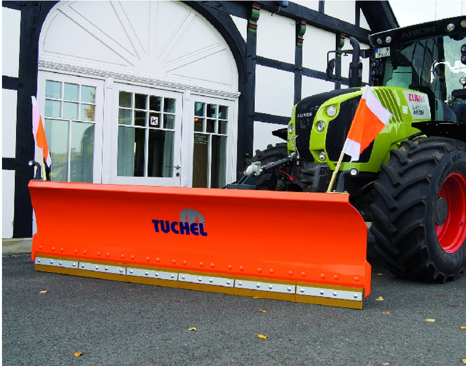
Ein Tuchel L-SF Schneeräumschild mit 275 cm Breite, hochabriebfestem Kommunalbesatz und StVZO-Ausrüstung.
