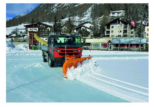
Der neue Zaugg-Schneepflug G 16 besticht durch sein geringes Gewicht und passt an Transporter, Zweiachsmäher, Geräteträger, kleinere Traktoren, Radlader/Teleskoplader, Kommunalfahrzeuge usw.
