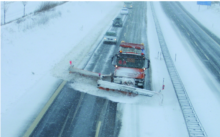
Zaugg Front- und Seitenschneepflug an einem 3-Achser-Lkw mit 7,5 m Räumbreite.
