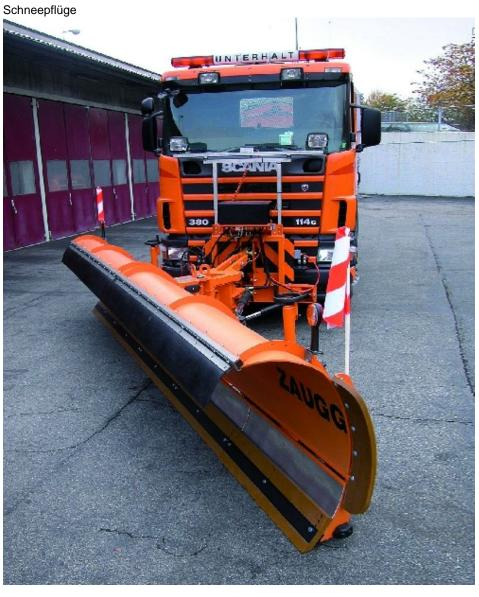
Ein Zaugg Lkw-Schneepflug mit maximal eingestelltem Schwenkwinkel.
