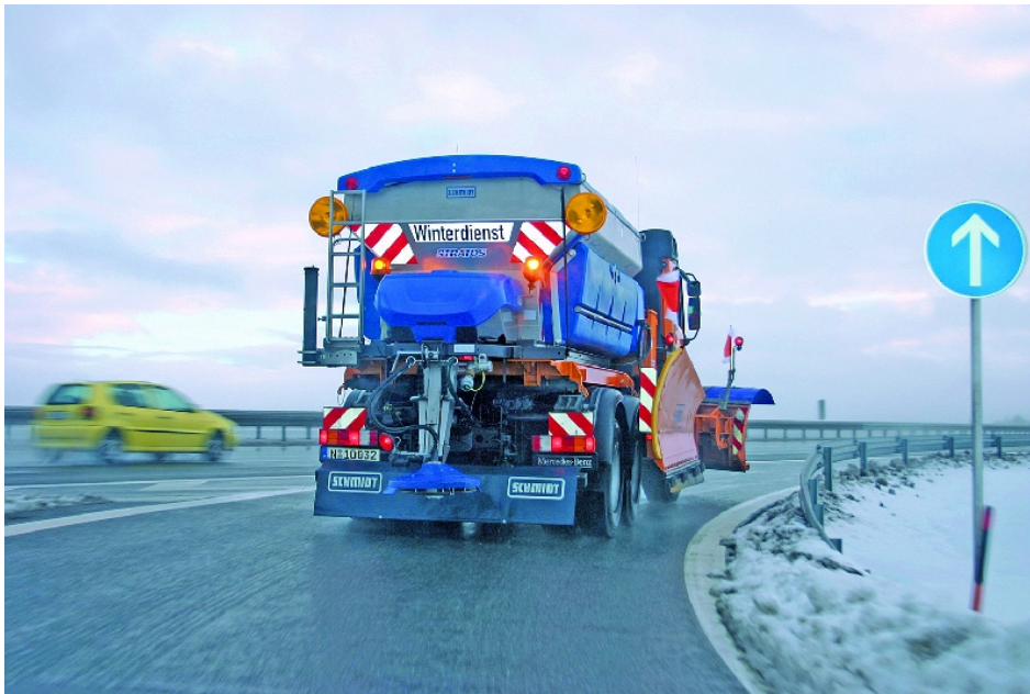
Ein Stratos Aufbaustreuer (Large) mit 4,0 bis 12 m 3 Behälter und Tarron-Schneepflug im Langstreckeneinsatz (Bild: Aebi Schmidt).
