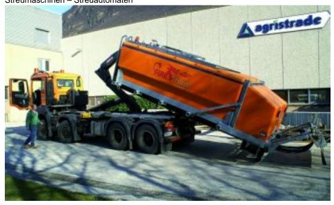
Dieser Agristrade »Firestorm«, auf Hackenrahmen und mit 12.000 I Solebehälter, ist für die Asfinag auf der Autobahn A21 bei Wien im Einsatz (Bild: Agristrade).
