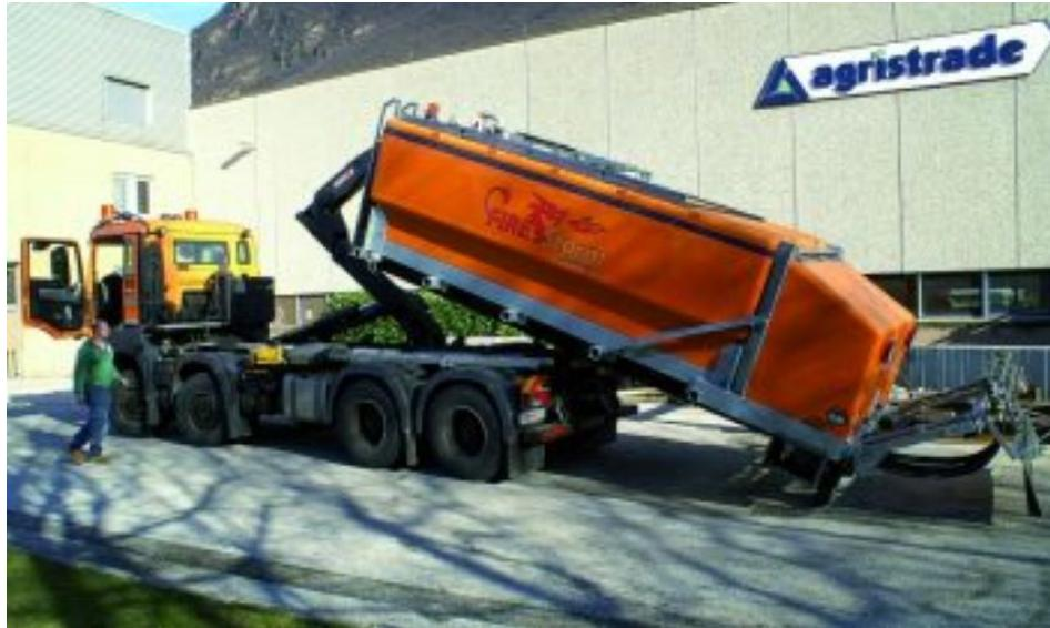
Dieser Agristrade »Firestorm«, auf Hackenrahmen und mit 12.000 l Solebehälter, ist für die Asfinag auf der Autobahn A21 bei Wien im Einsatz (Bild: Agristrade).
