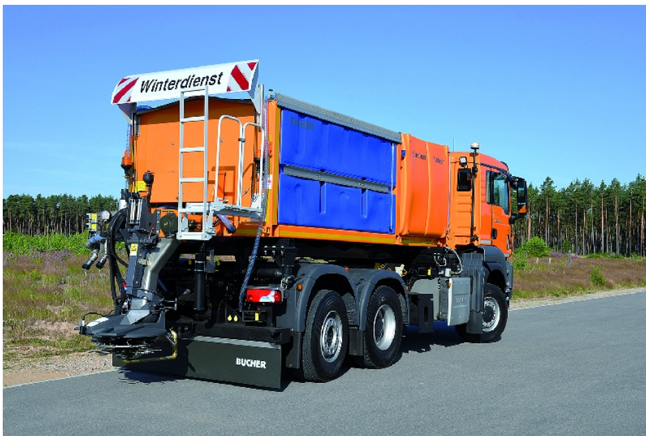
Der Streuautomat Icebear W60c mit der Sprüheinheit BrineStar (Bild: Bucher Municipal).
