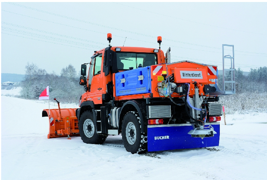
Bucher Streuautomat Yeti W18 mit Ramox-Schneepflug.
