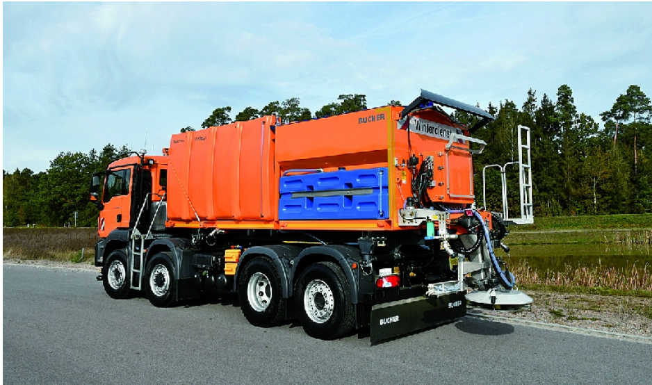
Icebear W60c mit 8580 l Sole und 6 m 3 Trockenstoff (Bild: Bucher Municipal).
