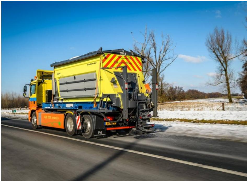
Der Bandstreuer »Sirius AST« ist in Behältergrößen bis 9 m<sup>3</sup> verfügbar. Hier im Einsatz auf einem rein elektrisch angetriebenen eTGM. (Bild: Epoke).
