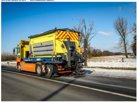
Der Bandstreuer »Sirius AST« ist in Behältergrößen bis 9 m³ verfügbar. Hier im Einsatz auf einem rein elektrisch angetriebenen eTGM. (Bild: Epoke).
