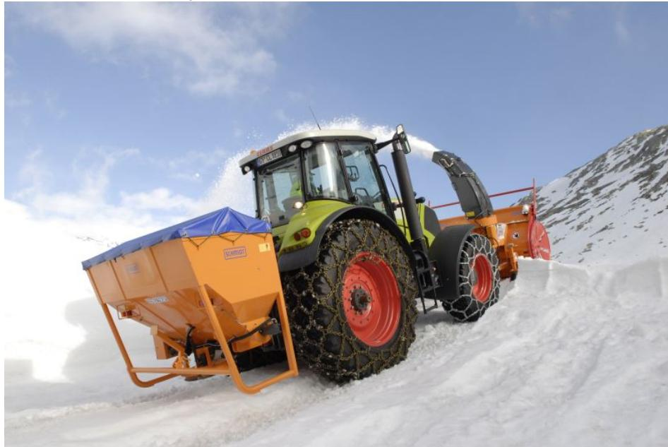
Der »Traxos« ist eine Anbau-Streumaschine, die es in verschiedenen Ausführungen sowie Behältergrößen von 0,5 bis 1,8 m<sup>3</sup> gibt (Bild: Aebi Schmidt).
