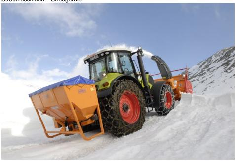
Der »Traxos« ist eine Anbau-Streumaschine, die es in verschiedenen Ausführungen sowie Behältergrößen von 0,5 bis 1,8 m³ gibt (Bild: Aebi Schmidt).
