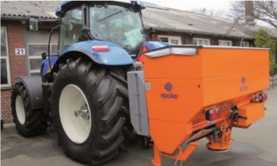
Der Traktorstreuer »TP 9« kann bei der Materialausbringung variabel zwischen Streuteller und Auslegewalze wechseln (Bild: Epoke).
