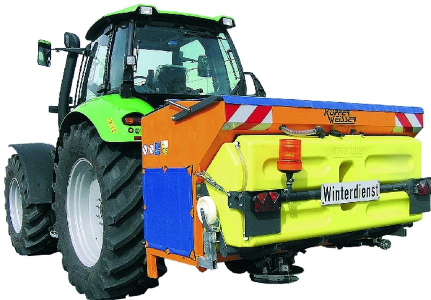
Unter der Bezeichnung IMS P hat der Streumaschinenhersteller Kupper-Weisser einen Streuer fur Traktoren mit Dreipunkt-Aufnahme im Programm. Die Behaltergroen reichen von 1,0 bis 2,0 m<sup>3</sup>.
