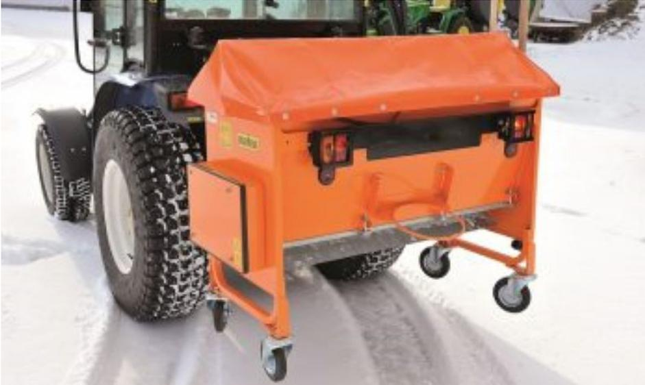
Durch eine mechanisch oder hydraulisch einstellbare Dosiermenge sorgt der matev-Kastenstreuer SPR-H/M für eine gleichmäßige Streuung.
