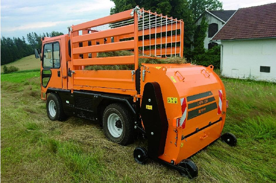
Für Schmalspur-Geräteträger haben Kalinke und Loipfinger eine Pick-up-Aufnahme mit gesteuerten Zinken und einer 2-Rotoren-Förderung entwickelt (Bild: Kalinke).
