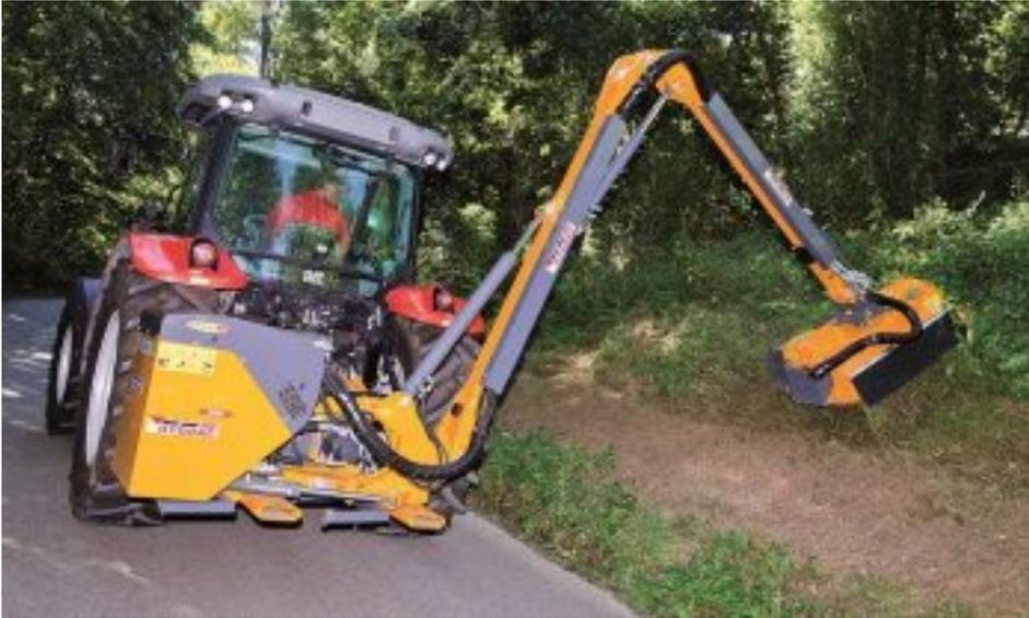
Hydrac produziert mit der BM-Serie ein gut sortiertes Programm an Böschungsmähern für den Front- und Heckenanbau für Traktoren ab 20 PS.
