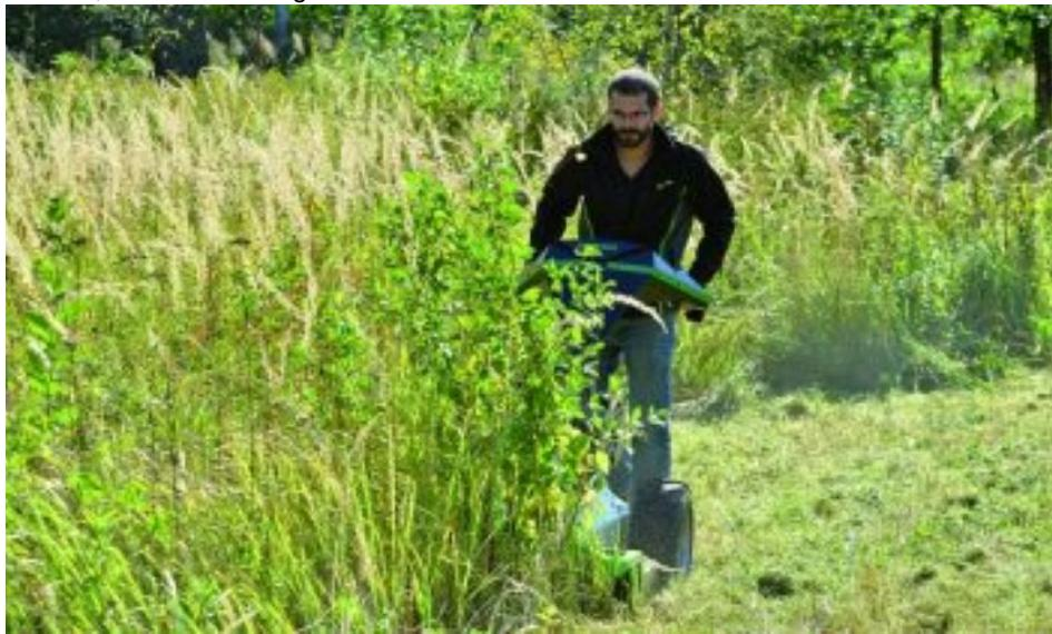
Neu bei Etesia: der Attila AH75 Gestrüppmäher mit 75 cm Schnittbreite und einem 7,3 kW starken Honda GXV390-OHV-Motor.
