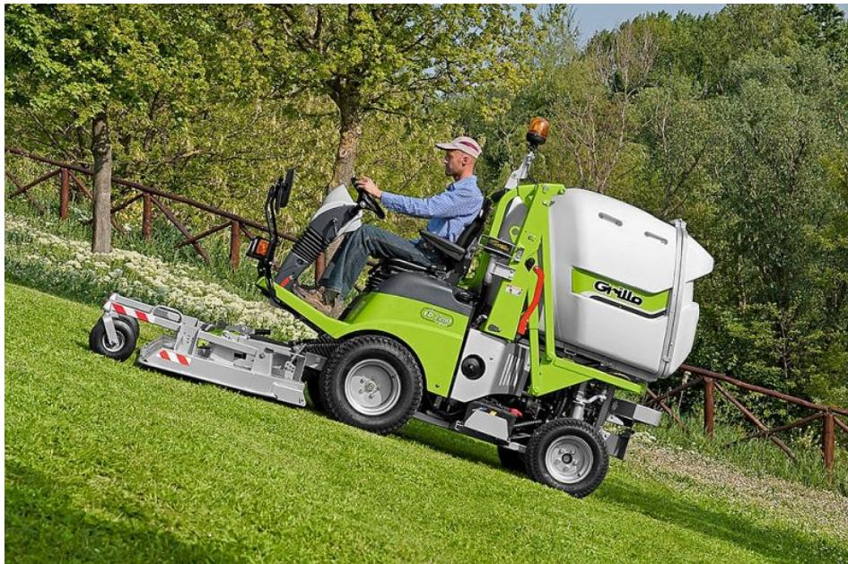
Der »FD 2200« kann mit einem Schlegelmäher mit Mulching-Balken ausgerüstet werden, der die Zerkleinerung des Grases erhöht (Bild: Grillo).
