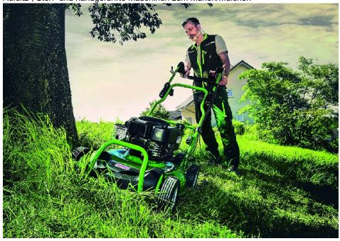
Mit seinen Mulchmessern zerkleinert der Sabo 53-Pro M Vario das gemähte Gras in kleinste Partikel, die dann den Boden auf natürliche Weise düngen.
