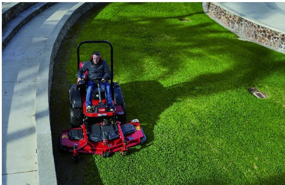
Die Frontsichelmäher mit Seiten- oder Heckauswurf, wahlweise mit Recycler-Kit, gewährleisten eine sehr hohe Schnittqualität bei gleichmäßiger Schnittgutverteilung (Bilder: Toro).
