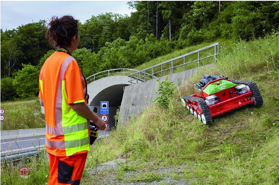
Der Elektro-Hybrid-Antrieb aus leistungsstarkem Verbrennungsmotor und elektrischen Fahrtrieben ist besonders leistungseffizient, kraftstoffsparend und wartungsfreundlich (Bilder: Agria-Werke).
