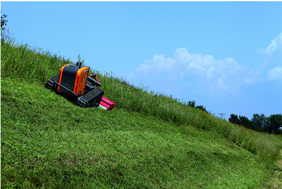
Ein RoboFlail Vario mit Frontmäherwerk (über Zapfwelle) im Steilhang (Bild: KommTek).
