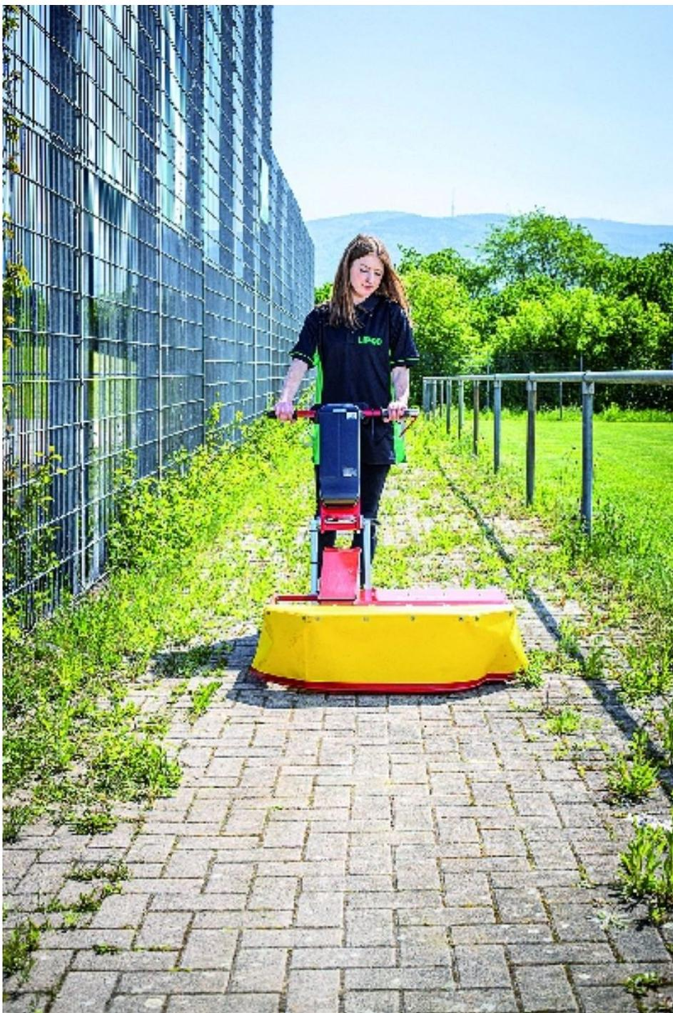
Das handgeführte Akku-Gerät rückt dem Wildkraut über mehrere Fadenköpfe mechanisch zu Leibe (Bild: Lipco).
