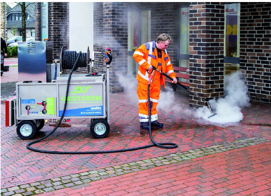
Stadiko Ökotherm mit Bewegungsschlauch und Handlanze zum Ausarbeiten von Ecken.
