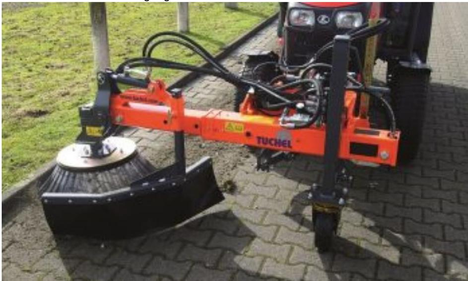
Tuchel hat eine neue Wildkrautbürste »WB 750« vorgestellt. Über die variable Seitenverschiebung ist sie an verschiedenen Trägerfahrzeugen einsetzbar (Bild: Tuchel).
