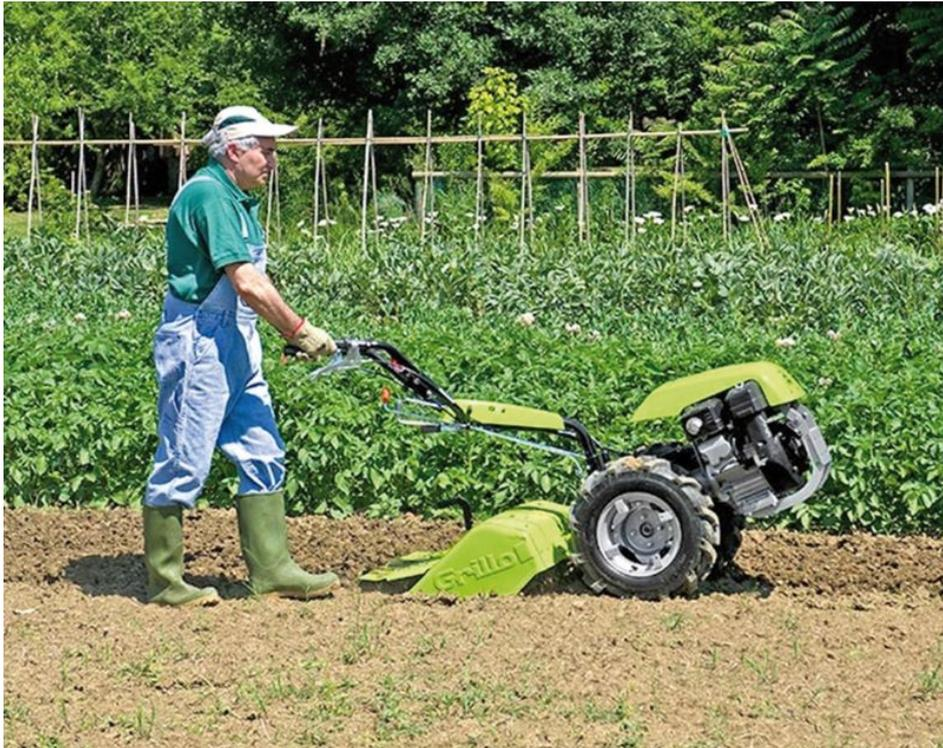
Die Fräse ist nur ein Zubehör, das man mit den Einachsschleppern von Grillo benutzen kann; eine weitgefächerte Zubehörpalette kann dank des reversiblen Lenkholms vor oder hinter der Maschine montiert werden.
