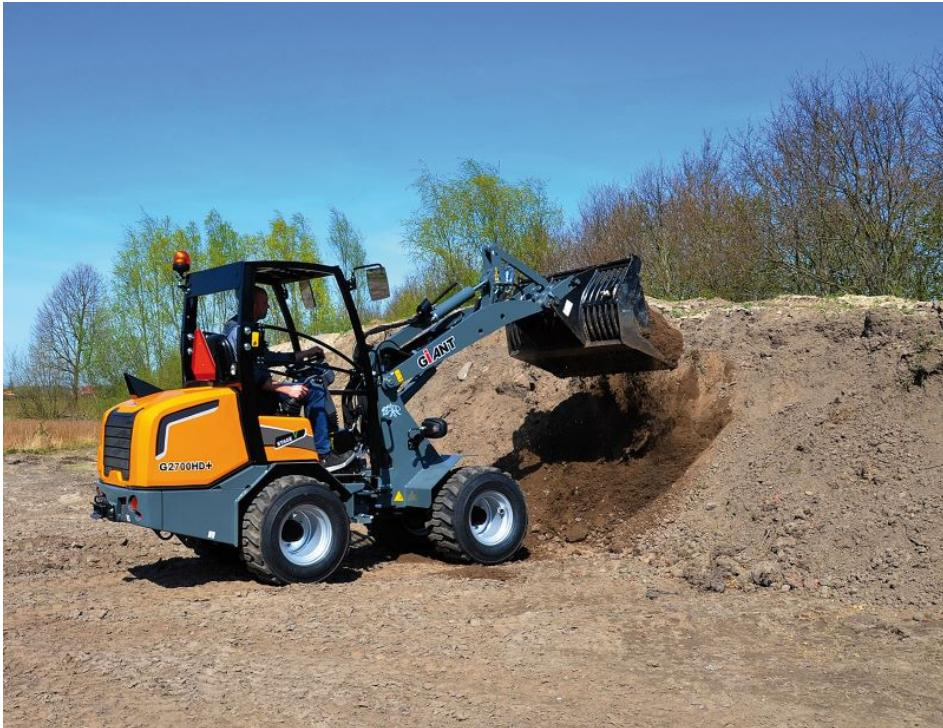
Mittels hydraulischem Schnellwechselsystem »G2700« sind Werkzeuge in Sekundenschnelle gewechselt (Bild: Tobroco-Giant).
