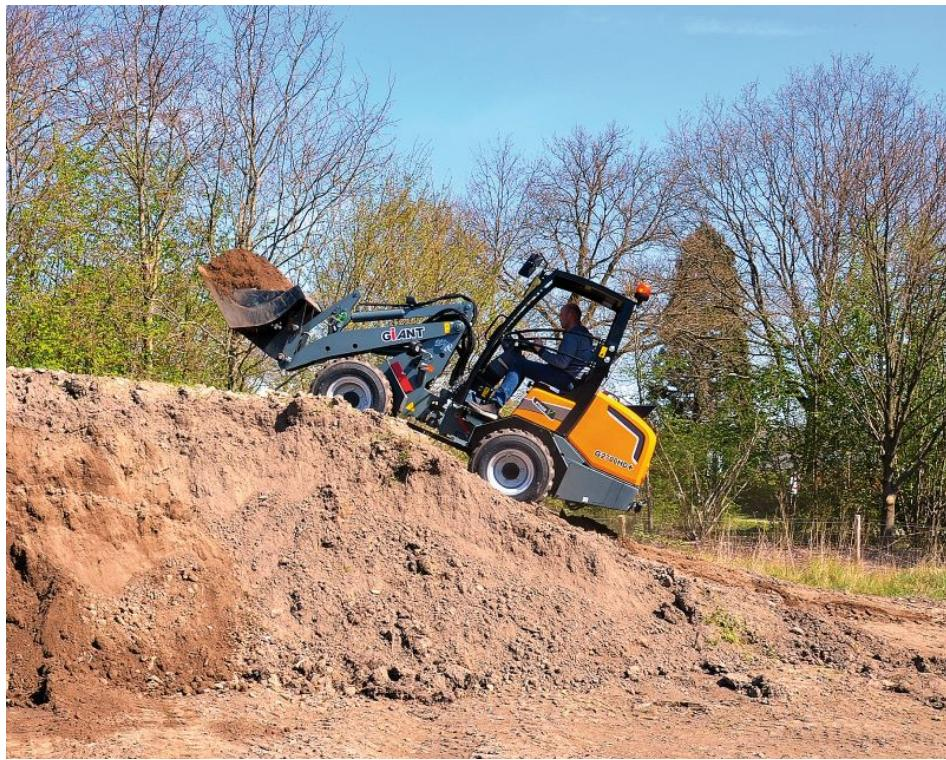
Mit allen vier Rädern bleibt der kleine Tobroco-Giant Radlader »G2700« fest am Boden und erhält so noch mehr Traktion (Bild: Tobroco-Giant).
