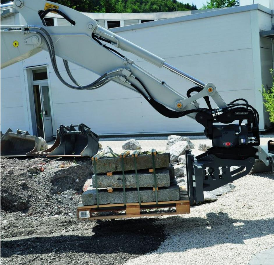
Ein Kinshofer-Schwenkrotator in Kombination mit Palettengreifer verwandelt einen Bagger nahezu in einen Gabelstapler.
