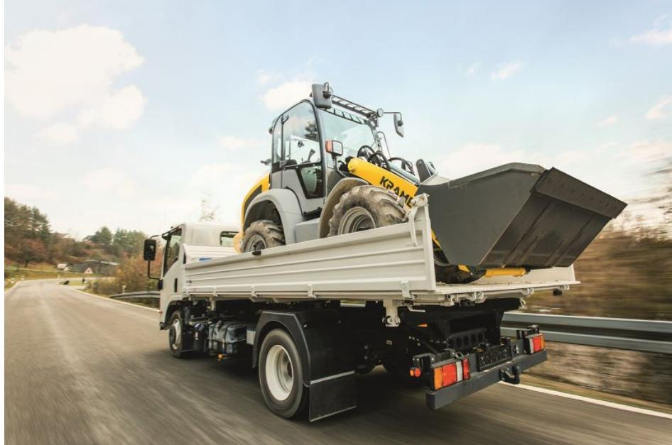
Der Kramer-Radlader »5050« hat ein geringes Eigengewicht mit bis zu 2,65 t. Zusatzgewichte (»Smart Ballast«) können am Heck hinzugefügt werden. Diese Anpassungsfähigkeit gewährleistet einen Transport auf einem 3,5-t-Anhänger oder Pritsche (Bild: Kramer).
