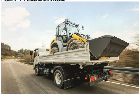
Der Kramer-Radlader »5050« hat ein geringes Eigengewicht mit bis zu 2,65 t. Zusatzgewichte (»Smart Ballast«) können am Heck hinzugefügt werden. Diese Anpassungsfähigkeit gewährleistet einen Transport auf einem 3,5-t-Anhänger oder Pritsche (Bidl: Kramer).
