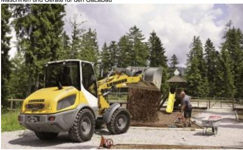
Der »L 506 Compact« ist der Einstieg in die Klasse der Liebherr-Compactradlader. Er hat eine Kipplast von 3450 kg (Bild: Liebherr).
