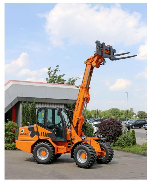
Mit einer Hubhöhe von 4,95 m bietet der »6680 T« ideale Voraussetzungen zum Verladen und Stapeln von Paletten sowie zum Beladen von Streuwagen (Bild: Schäffer).
