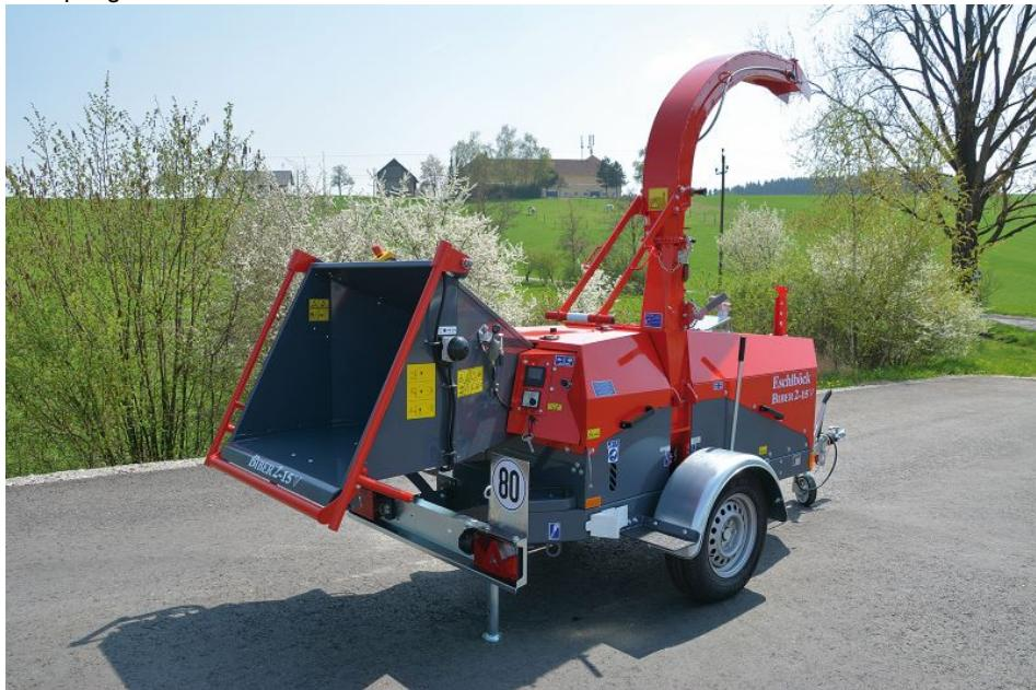
Der Trommelhacker Biber 2-15 V ist mit einem leistungsstarken Kohler-Dieselmotor mit 28 kW und 133 Nm Drehmoment ausgestattet (Bild: Eschlöök).
