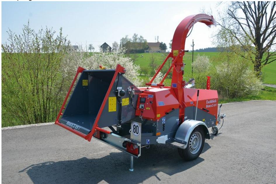
Der Trommelhacker Biber 2-15 V ist mit einem leistungsstarken Kohler-Dieselmotor mit 28 kW und 133 Nm Drehmoment ausgestattet (Bild: Eschlböck).
