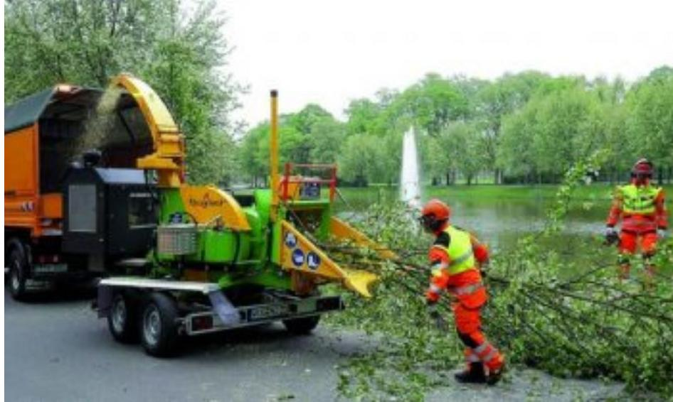
Robuste Trommelhackmaschine HM 6-300 VM von Heizomat. Der Caterpillar-Motor erfüllt die aktuell gültige Abgasnorm Emissionsklasse Tier 4 Final.
