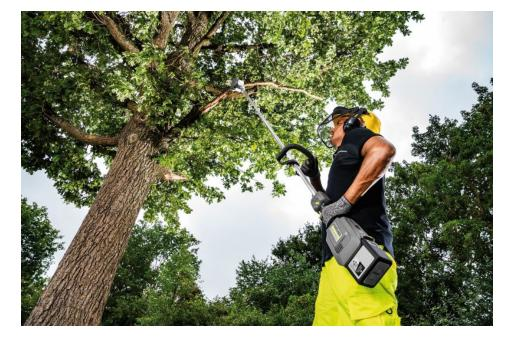
Das Multi-Tool mit Sägen-Aufsatz zum Entasten. Die Akkus sind generell in die Geräte integriert (Bild: Kärcher).
