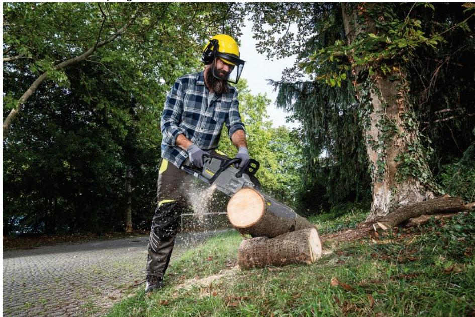
Ohne Abgase und dank reduzierter Vibrationen ist die Akku-Kettensäge »CS 400/36 Bp« besonders anwenderfreundlich (Bild: Kärcher).
