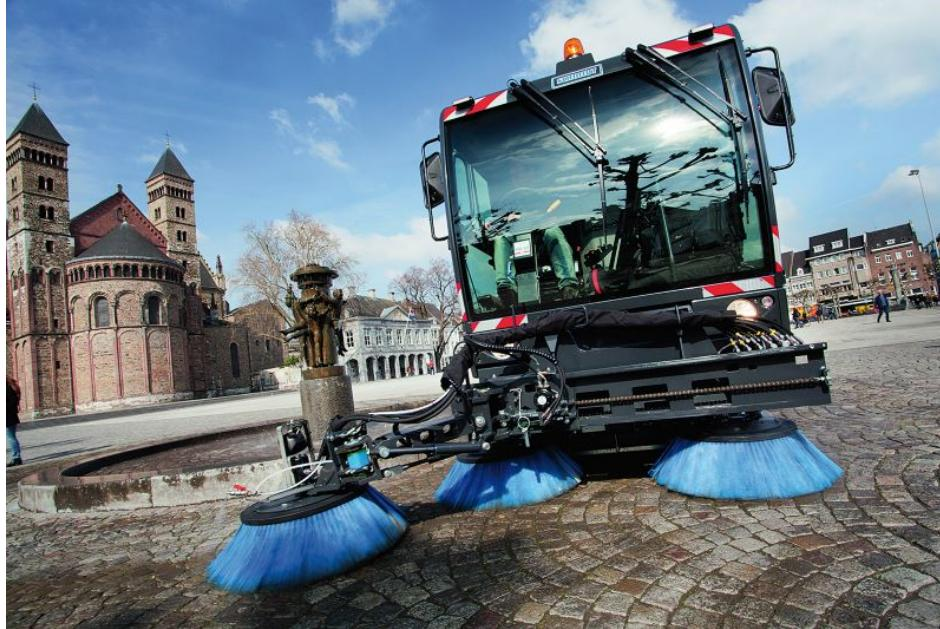
So arbeiten die Tellerbesen im Einsatz nicht einfach nur in der Schwimmstellung, sondern lassen sich überdies mit einem unabhängigen Bodenaufflagedruck hydraulisch steuern (Bild: Aebi Schmidt).
