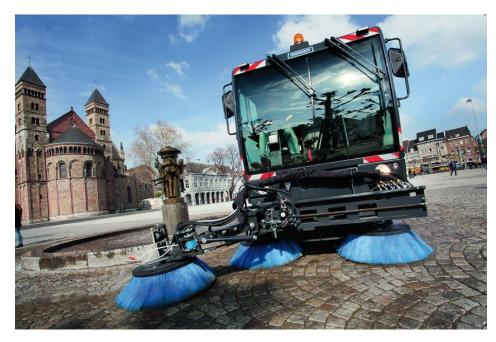
So arbeiten die Tellerbesen im Einsatz nicht einfach nur in der Schwimmstellung, sondern lassen sich überdies mit einem unabhängigen Bodenauflagedruck hydraulisch steuern (Bild: Aebi Schmidt).
