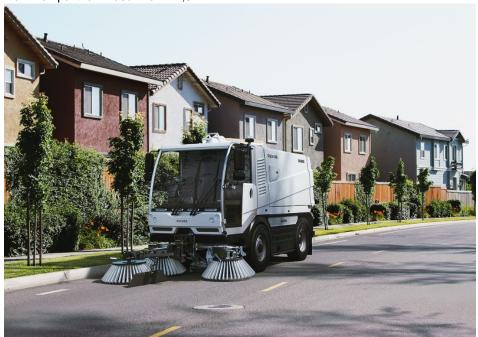
Kehrmaschine »CityCat 5006« mit 118 kW starkem Dieselmotor in Euro 6 und einem Behältervolumen von 4,3 m³ netto (Bild: Bucher Municipal).
