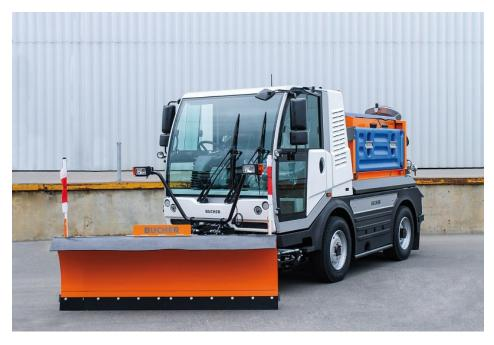
Das modular auf einem Lkw-Chassis basierende Reinigungsfahrzeug hat eine enorme Saugleistung und Reichweite (Bild: Bucher Municipal).
