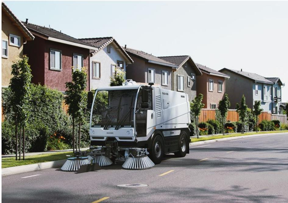
Kehrmaschine »CityCat 5006« mit 118 kW starkem Dieselmotor in Euro 6 und einem Behältervolumen von 4,3 m<sup>3</sup> netto (Bild: Bucher Municipal).
