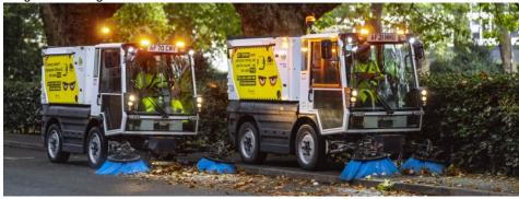
Die »eSwingo 200+« ist mit zwei unabhängigen Kehrsystemen erhältlich. Ein geschobenes 2-Besensystem mit Besendurchmesser 850 mm oder ein gezogenes 3-Besensystem mit Besendurchmesser 800 mm (Bild: Aebi Schmidt).
