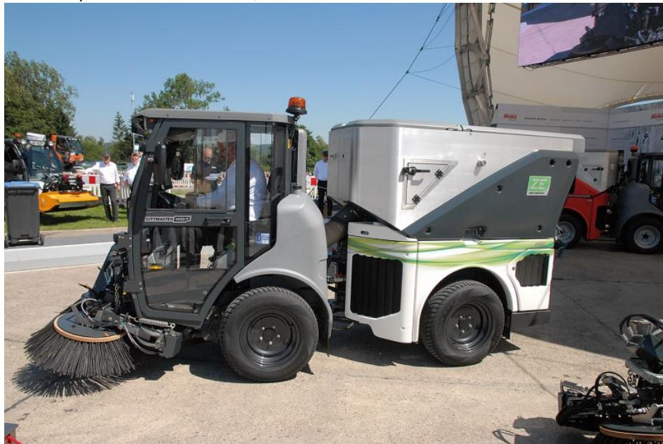
Es geht los: Hako hat auf der demopark mit dem Citymaster 1650 ZE seine elektrisch angetriebene Kehrmaschine als Funktionsmuster vorgestellt Bild: Hako).
