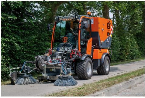
$\label{thm:continuous} \mbox{Vielseitig einsetzbar} - \mbox{etwa zum Kehren und Laubsammeln} - \mbox{ist die neue Kehrmaschine SX 1200 von Holder (Bild: Holder)}.$
