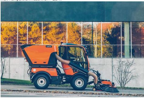
Holder bietet für seine C-Baureihe der mittleren Leistungsklasse (50 bis 67 PS) die Kehrsaug-Kombination KS 1200 an (Bild: Holder).
