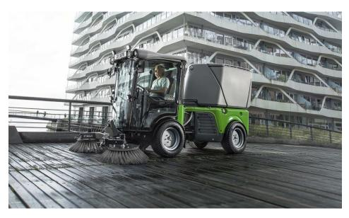
Mit einem Gesamtgewicht von drei Tonnen und einer Motorleistung von etwa 70 PS wird er in vielen Bereichen als starker Konkurrent in dieser Maschinenklasse bis 1 m³ Kehrgutbehälter auftreten (Bild: Egholm).
