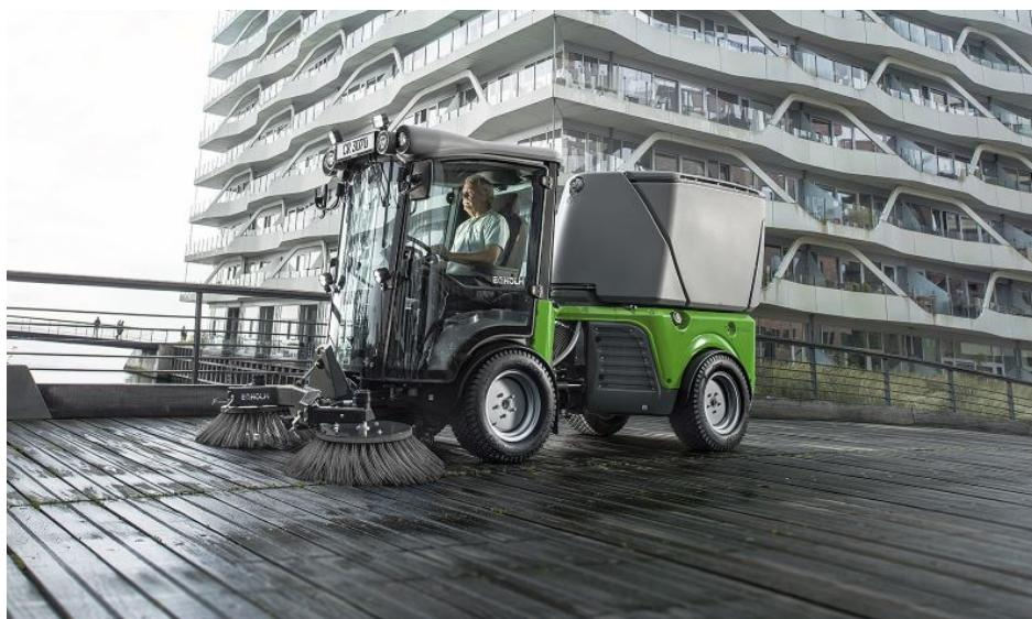
Mit einem Gesamtgewicht von drei Tonnen und einer Motorleistung von etwa 70 PS wird er in vielen Bereichen als starker Konkurrent in dieser Maschinenklasse bis 1 m<sup>3</sup> Kehrgutbehälter auftreten (Bild: Egholm).
