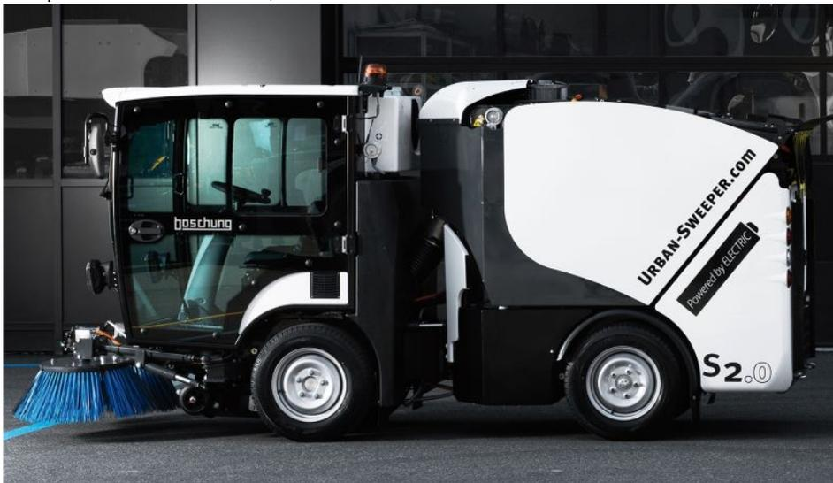
Kompakt und wendig ist die »Urban-Sweeper S2« schon von Haus aus. Jetzt läuft sie in der Version »S2.0« auch elektrisch und optional auch ganz autonom (Bild: Boschung).
