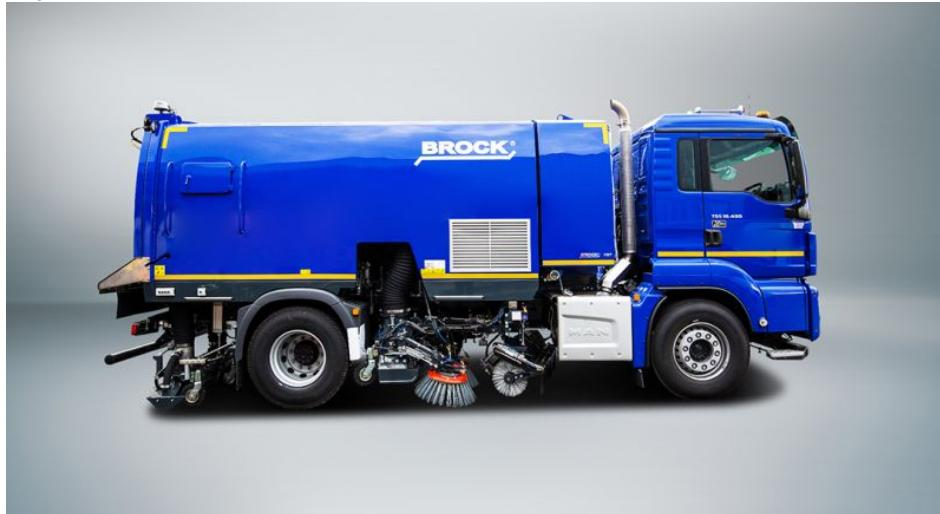
Je nach Zusatzausstattung reicht die Kehr-/Waschbreite der »VS7« von 2500 bis zu 5050 mm mit einem frontseitigen Spezialbesen (Bild: Brock).
