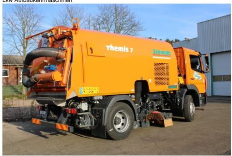
Zwei Kehraufbauten namens »Themis« hat Schmidt Kommunalfahrzeuge für Lkw-Fahrgestelle im Programm – mit 4 oder 7 m³ Behältervolumen (Bild: Schmidt Kommunalfahrzeuge).
