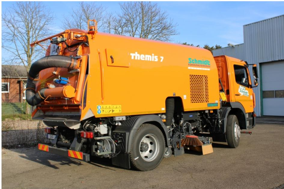
Zwei Kehraufbauten namens »Themis« hat Schmidt Kommunalfahrzeuge für Lkw-Fahrgestelle im Programm – mit 4 oder 7 m<sup>3</sup> Behältervolumen (Bild: Schmidt Kommunalfahrzeuge).
