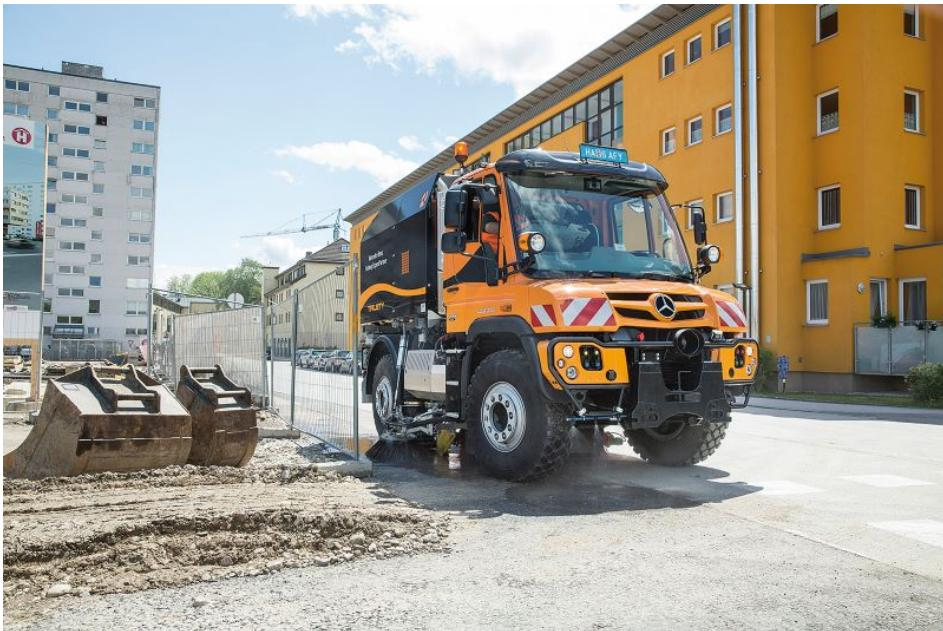
Kehraufbauten in verschiedenen Behältergrößen (3,4 bis 5,8 m<sup>3</sup>) hat Trilety auf den Unimog zugeschnitten (Bild: Trilety).
