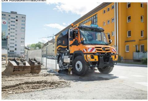
Kehraufbauten in verschiedenen Behältergrößen (3,4 bis 5,8 m³) hat Trilety auf den Unimog zugeschnitten (Bild: Trilety).
