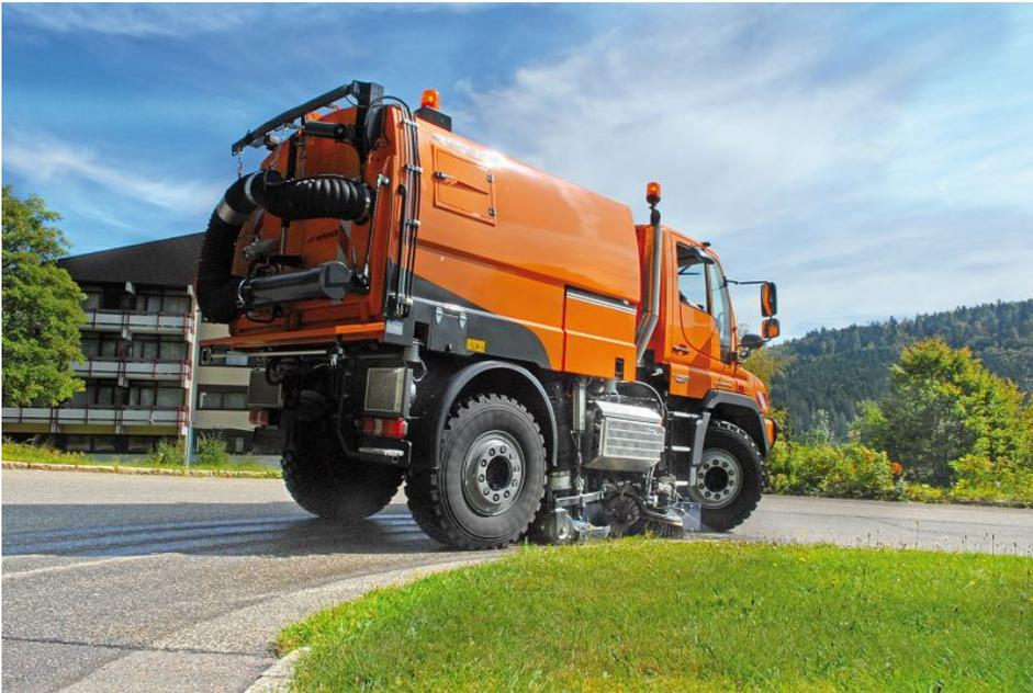
Die »SK 350« ist eine Wechselaufbau-Kehrmaschine für Unimog-Fahrgestelle (Bild: Aebi Schmidt).
