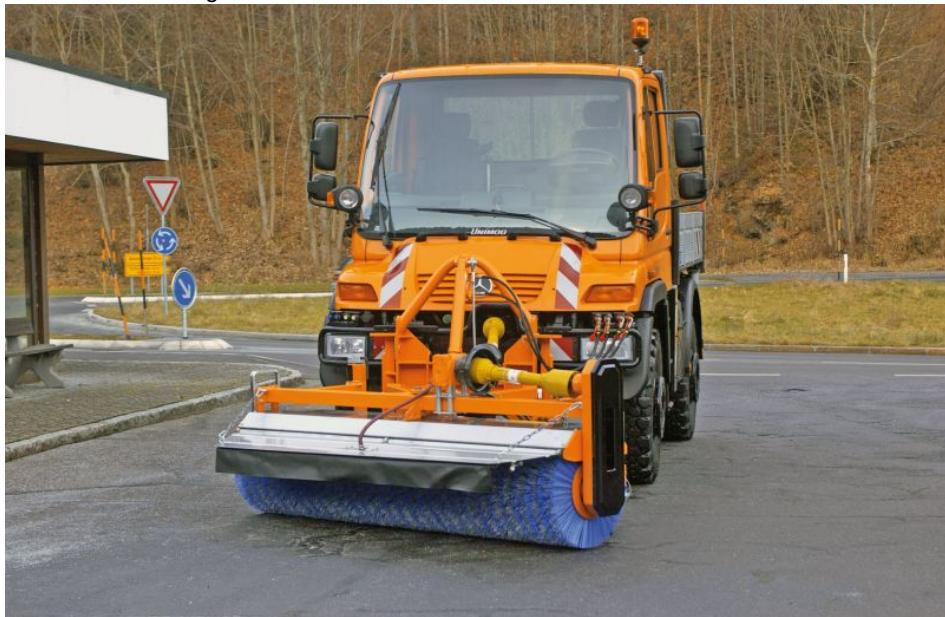
Die Anbaukehrmaschinen des Typs »LKS« und »VKS« (im Bild) bieten hohe Flächenleistungen (Bild: Aebi Schmidt).
