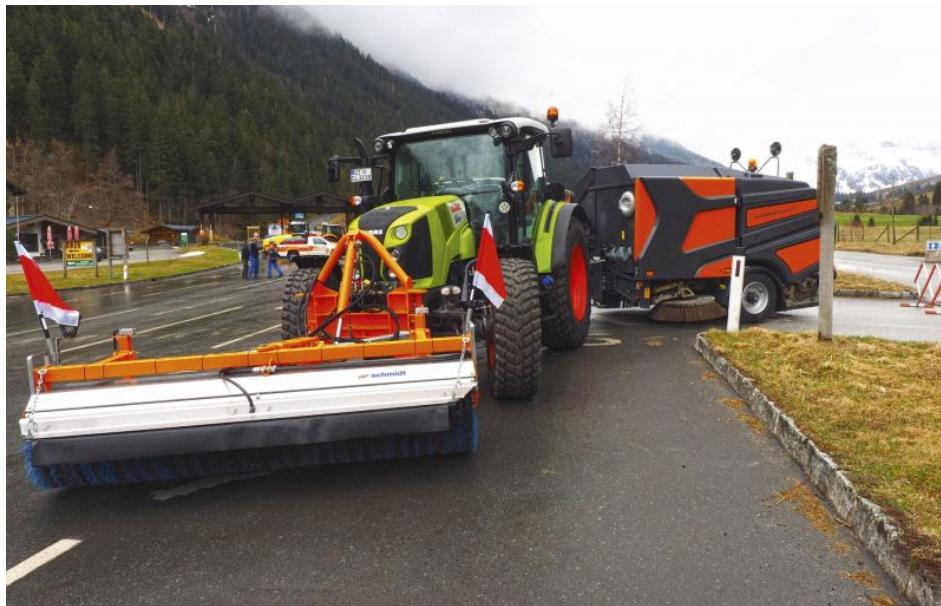
Ein starkes Doppel: Eine Frontkehrwalze »LKS« und die »Wasa 300+«. Die Anhängermaschine kehrt auf einer Breite bis zu 2400 mm und sammelt das Kehrgut in einem 3 m<sup>3</sup> großen Behälter (Bild: Aebi Schmidt).
