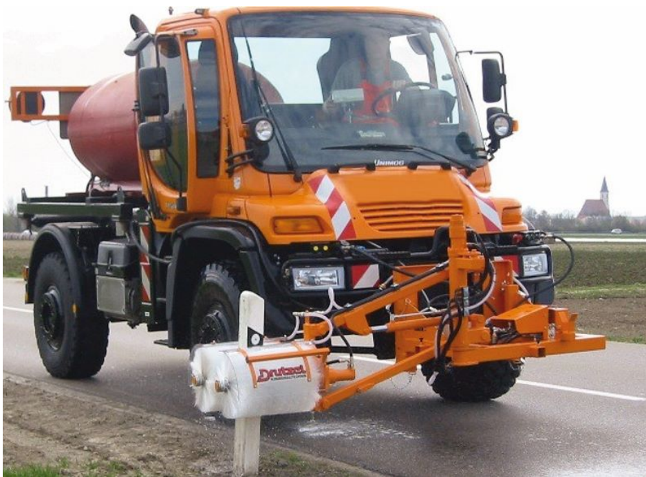
Ein Unimog mit Drutzel Leitpfostenwaschgerät LWG-U-300 (Bild: Drutzel).
