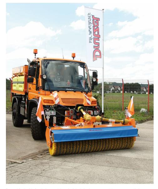
Drutzel fertigt Vorbaukehrmaschinen in Arbeitsbreiten von 1,9 bis 2,4 m zum Anbau an verschiedenste kommunale Geräteträger (Bild: Drutzel).
