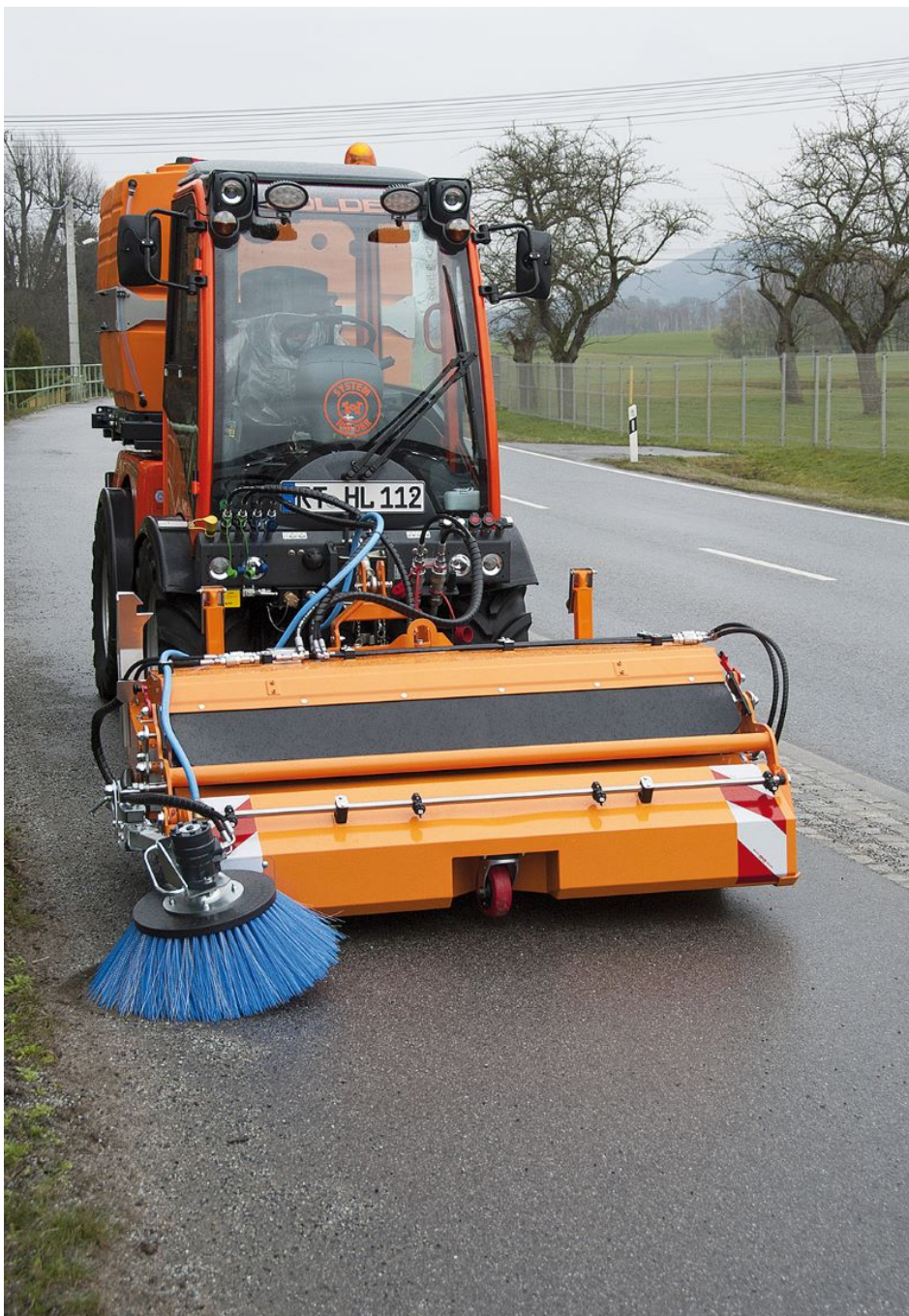
Frontkehrmaschine Fiedler FFK 1610 mit Seitenbesen und optionaler Wassersprengereinrichtung (Bild: Fiedler).
