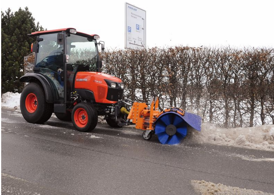
Frontkehrmaschine FKMZ 1310 mit mechanischem Zapfwellenantrieb und Winterbürstensatz (Bild: Fiedler).
