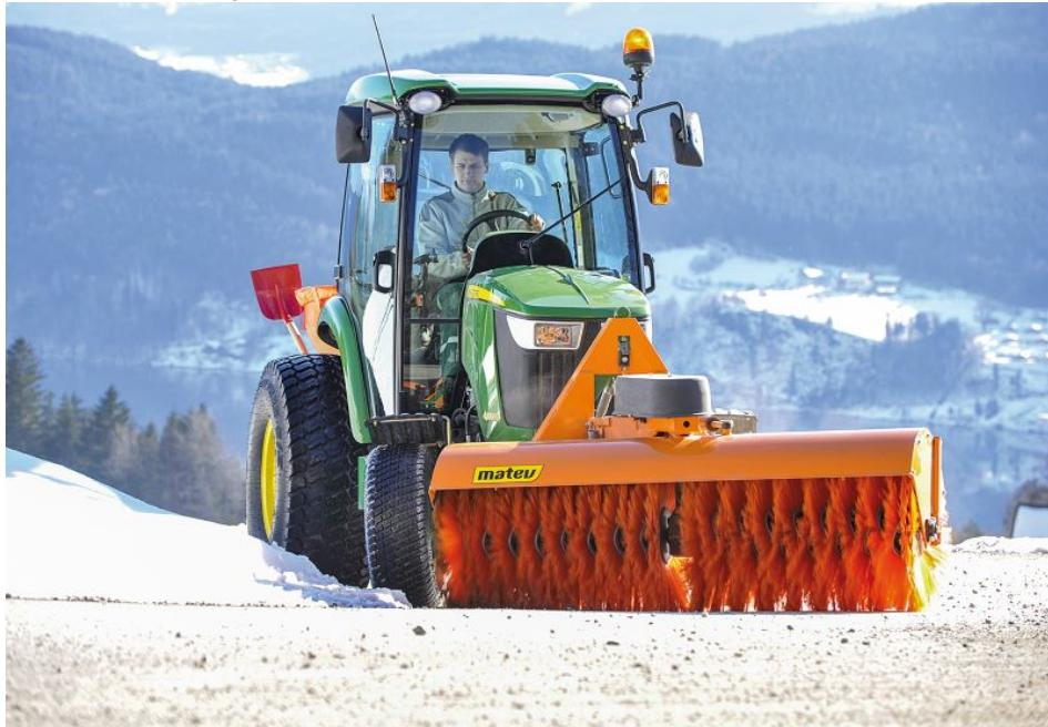
Die serienmäßige hydraulische Winkelverstellung der Kehrwalzen verbessert die Möglichkeiten zur Anpassung an die unterschiedlichsten Bedingungen (Bild: matev).
