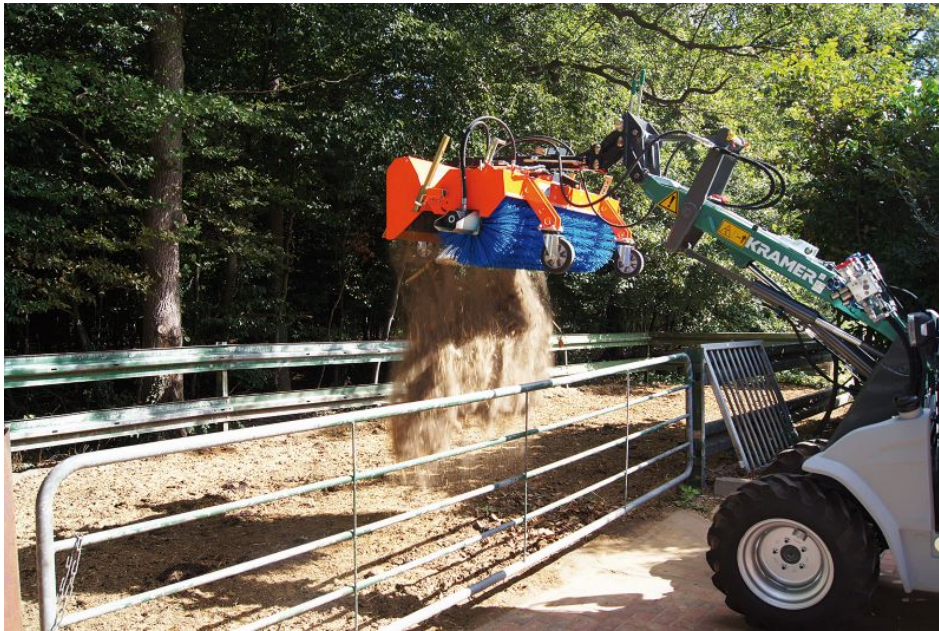
Hydraulische Entleerung des Schmutzsammelbehälters der Kehrmachine »Eco Pro« (Bild: Tuchel).
