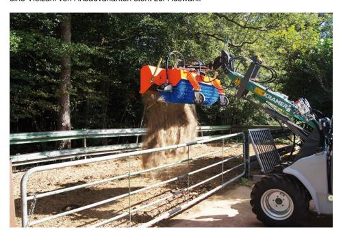
Hydraulische Entleerung des Schmutzsammelbehälters der Kehrmaschine »Eco Pro« (Bild: Tuchel).
