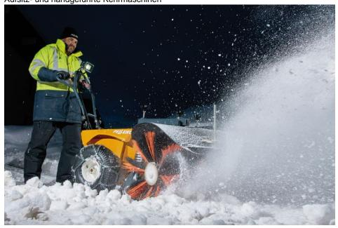
Leise reinigen: Mit der akkubetriebenen Kehrmaschine »Cleanion« klappt das auch in lärmsensiblen Bereichen und für ca. fünf Stunden Einsatzzeit (Bild: Pellenc).
