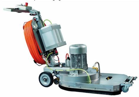
Drei rotierende Bürsten und heißer Niederdruck-Dampf lösen die verschiedensten, hartnäckigen Verschmutzungen, wie z. B. Kaugummi, am Boden (Bild: Zaugg).
